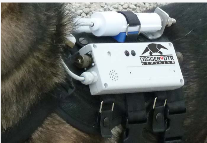
Ergonomietest und Anpassung des Geschirrs unter Realbedingungen in der Nähe von Sarajewo. Das Geschirr wurde ebenfalls nach Mass entwickelt, wobei das Wohlbefinden des Hundes im Mittelpunkt stand.
